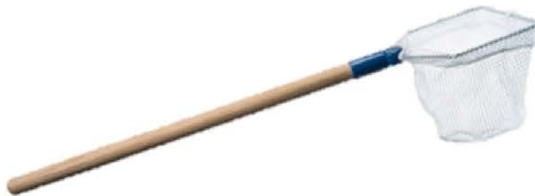
Una red D fabricada con un palo de escoba, un un aro de metal y una malla. El aro debe tener un ancho de 30 centímetros.
